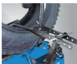
Настройка устройства расширения
