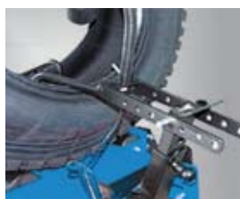
Настройка устройства расширения
